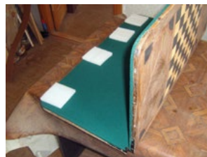
6. ОЧИСТКА И ПРИКЛЕИВАНИЕ К ОБРАТНОЙ СТОРОНЕ РАСКЛАДНОЙ СТОЛЕШНИЦЫ
