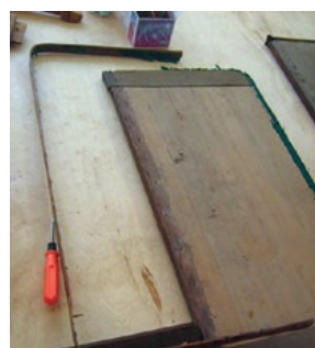
5. СНЯТИЕ МЕТАЛЛИЧЕСКИХ ЭЛЕМЕНТОВ КРЕПЛЕНИЯ ДЛЯ ОЧИСТКИ И ВОССТАНОВЛЕНИЯ УТРАЧЕННЫХ ФРАГМЕНТОВ
